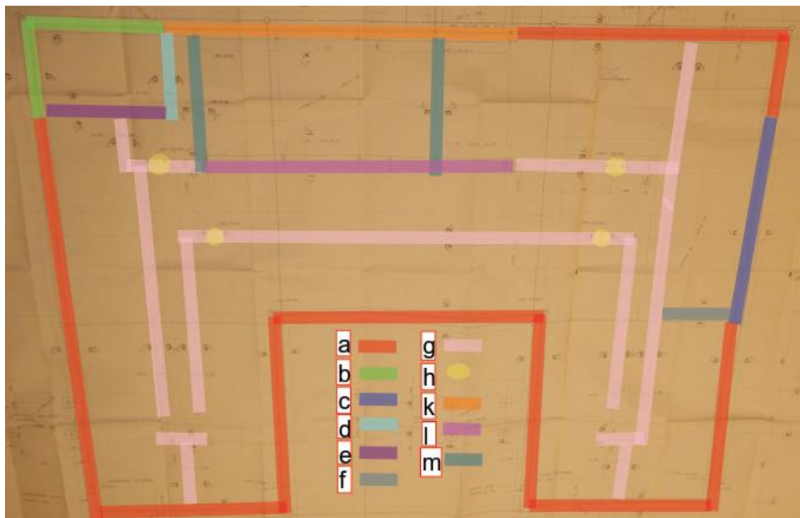
Kuva 8. Reunavahvistettu laatta. Kuvassa korostettu väreillä erityyppiset perustus-seinäliittymät.
